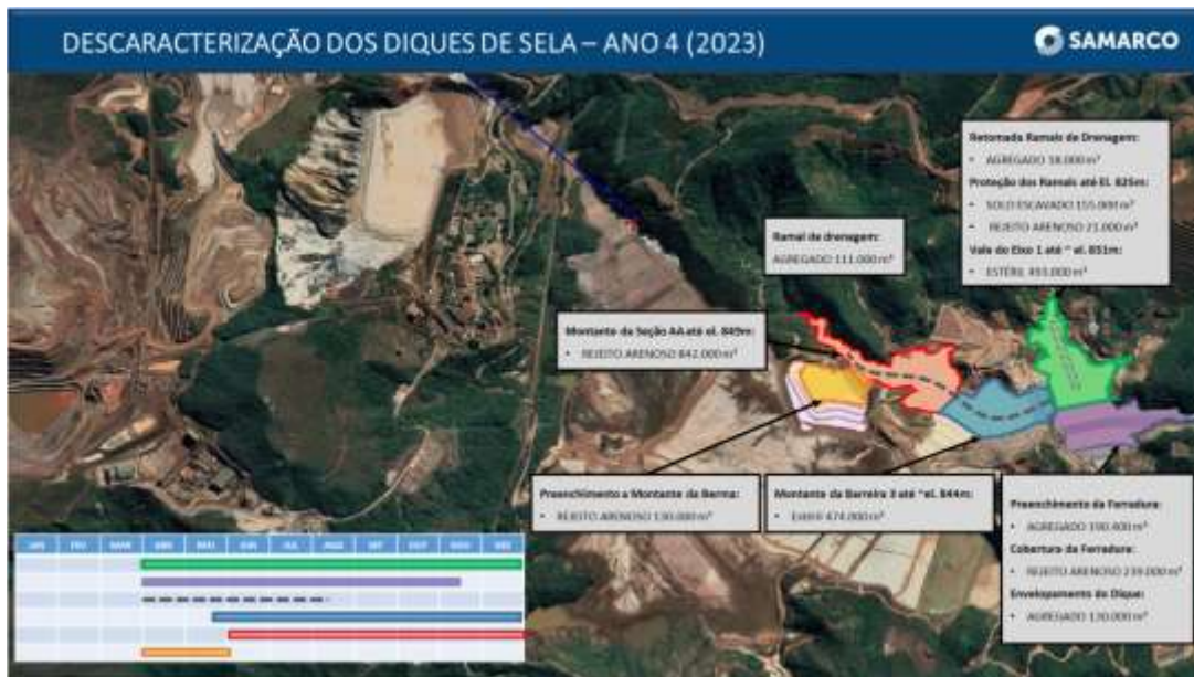
Figura 4: Ano 4 (2023) – Descaracterização dos Diques
